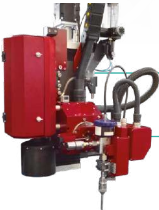
5 axis cutting system ±55° with Hydro-Finish Device. Sistema per il taglio a 5 assi ±55° accoppiato al sistema di Idro-Finitura
