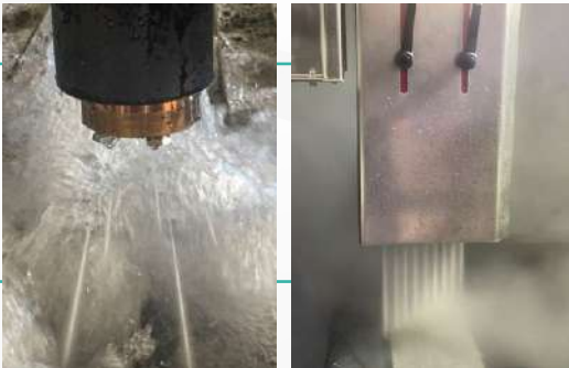
The equipment is able to texture all stone materials by water only. L'impianto permette di trattare e decorare superficialmente tutti i materiali lapidei solo con getto d'acqua.
