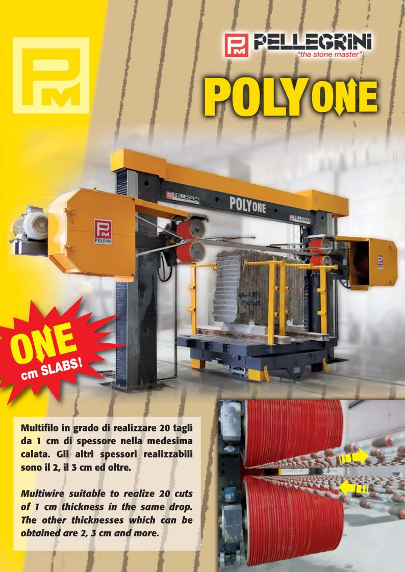
Caratteristica unica nel suo genere e brevettata della serie POLYONE consiste in una particolare geometria dell'avvolgimento del filo che permette di eseguire per ogni filo diamantato due tagli nel blocco. Con la versione POLYONE 20 è possibile quindi ottenere con 10 fili 20 tagli nel blocco per eseguire spessori da 1 cm, con 7 fili 14 tagli da 2 cm, e con 5 fili 10 tagli da 3 cm di spessore.
