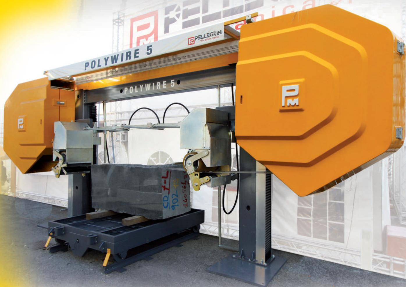
**E' l'evoluzione del noto modello precedente, caratterizzato da una robusta struttura a portale sulle cui colonne scorrono verticalmente, su guide a ricircolo di sfere, le slitte che supportano da un lato il tamburo motore di grande diametro e dall' altro i cinque volani tensionatori.**
