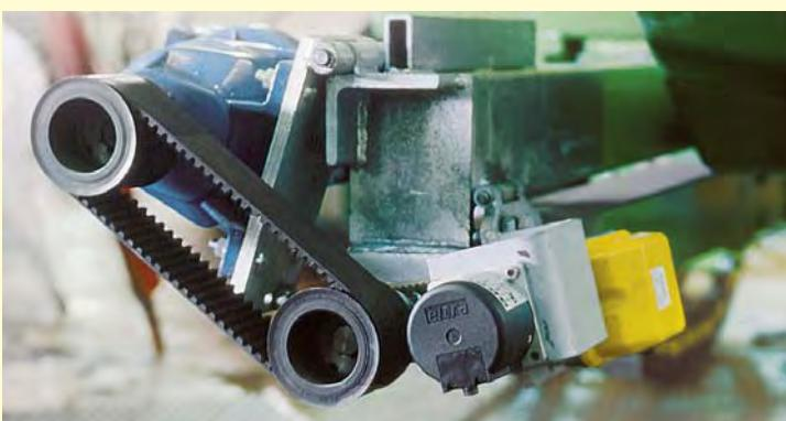
Attuatore elettrico per facilitare la manovra di avvicinamento/allontanamento dei volanetti guidafilo.
