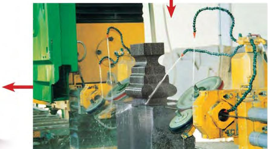
Lo spostamento verticale dei volanti, quello orizzontale del carro portablocchi e la rotazione sui 360° delle due coppie di volanetti guidafilo, sono singolarmente azionati da motori brushless e controllati in fase di lavoro da un elaboratore che coordina tra loro i vari movimenti per realizzare esattamente il profilo voluto.
