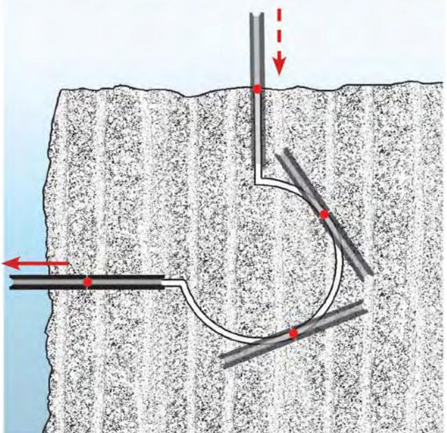
La velocità lineare del filo diamantato è regolabile tramite inverter da 0 a 40 m/sec in base al tipo di materiale da tagliare, mentre quella di lavoro è regolabile da 0 a 999 cm/ora e si autoriduce senza mai annullarsi in funzione del grado di difficoltà presentato dalla parte di profilo da eseguire, nell'istante considerato. Questo consente di ottenere superfici tagliate perfettamente lisce e pronte per le successive fasi di lavorazione. Il carro portablocchi ha una portata di 25 Tonn.
