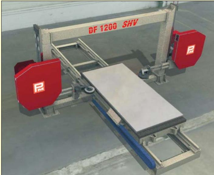
L'impianto monta una struttura rigida autoportante, il movimento sali-scendi delle carrelliere dei gruppi volani è indipendente su ciascun lato ed avviene su guide a ricircolo di sfere, facilitando l'allineamento del filo alla posizione della lastra da scoppiare. L'impianto è completo di carro porta blocchi da 20 tons che è parte integrante della struttura della macchina.
