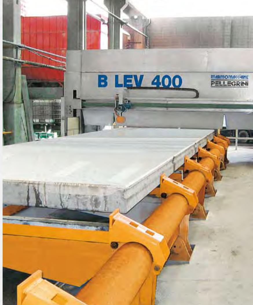
La linea è normalmente completa di banco porta-pannello con forche rivestite in plastica e con piano basculante inclinabile fino a 70° per facilitare le operazioni di carico e scarico. Alcuni accessori: pannello di controllo separato dalla macchina, gruppo orientabile con mola per la levigatura delle ceste del pannello, radiocomando per controllo a distanza, sistema di sicurezza perimetrale per proteggere la zona di lavorazione.
