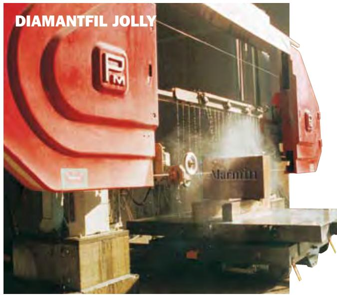
Dotato di CNC a due assi permette di eseguire anche profili bidimensionali.
