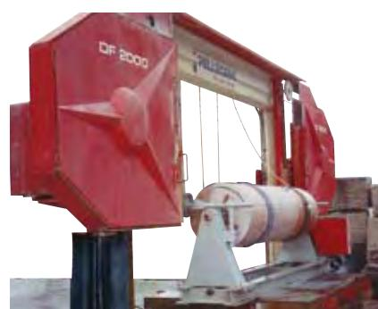
Tornio a filo diamantato per l'esecuzione di colonne (cilindriche o coniche, cave o piene) partendo da masselli con sezione quadrata.
