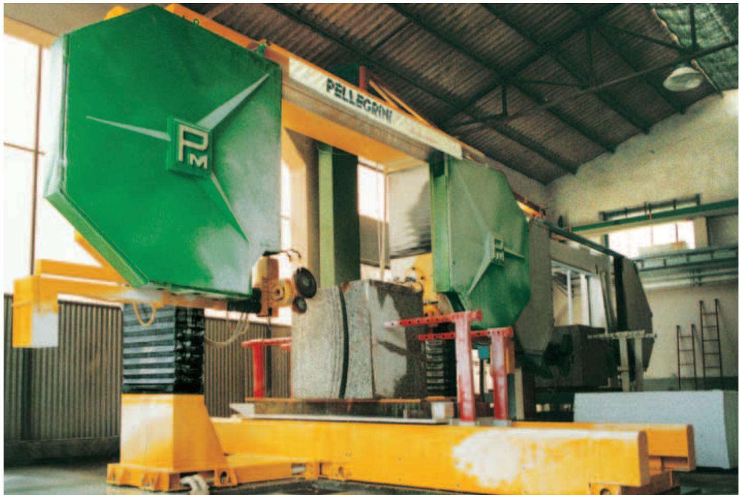
**La velocità lineare del filo diamantato è regolabile tramite inverter da 0 a 40 m/sec in base al tipo di materiale da tagliare, mentre quella di lavoro è regolabile da 0 a 999 cm/ora e si autoriduce senza mai annullarsi in funzione del grado di difficoltà presentato dalla parte di profilo da eseguire, nell'istante considerato. Questo consente di ottenere superfici tagliate perfettamente lisce e pronte per le successive fasi di lavorazione.**
